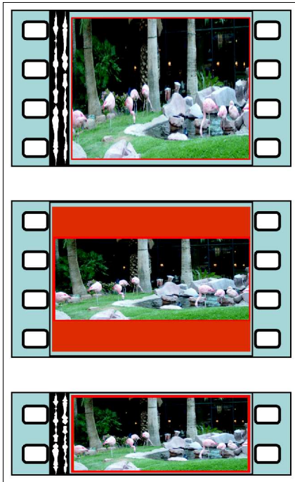
A 2,35 oldalarányú képet a Cinemascope formátum összenyomja (felül), kitakarásos esetben a teljes képet használják, a gazdaságos Techniscope formátum pedig fele sebességgel továbbítja a szalagot (alul).
