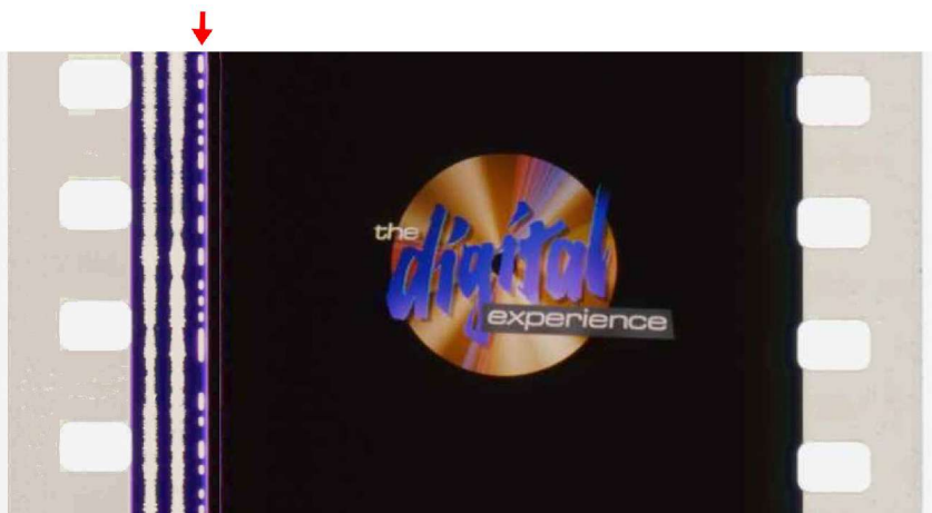
A DTS hang külső CD lemezekről szól, melyeket a szinkronizáló jelek vezérelnek.
