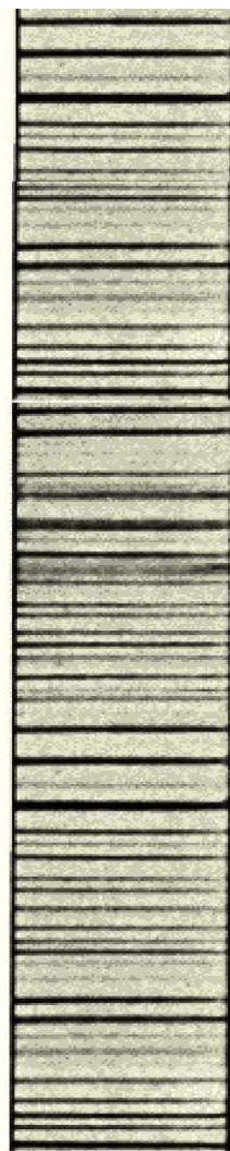
Régi filmekben gyakran a hangcsík denzitásának változása írta le a hanghullámot (variable density).
